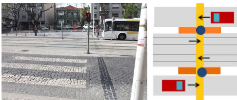
Figura 24 – Atravessamento semaforizado na Av. Nuno Álvares Cabral e descritor de configuração e conflitos
